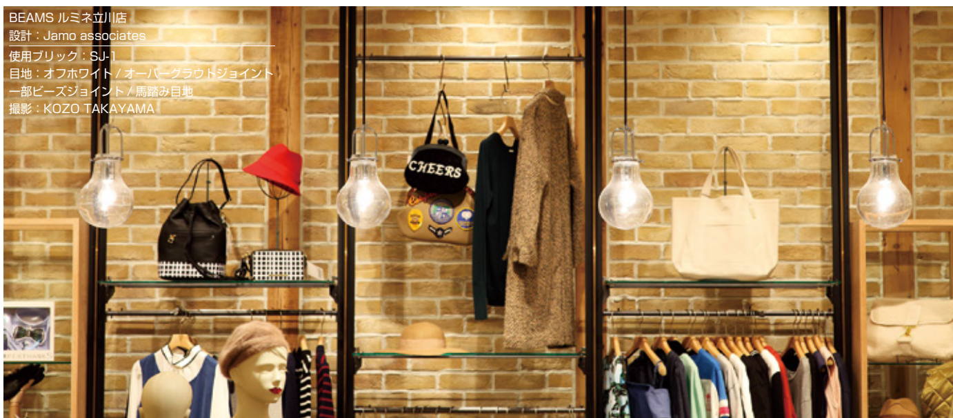
SJ-1 目地色：オフホワイト / 目地仕上げ：オーバーグラウトジョイント / 目地パターン：馬蹄目地
