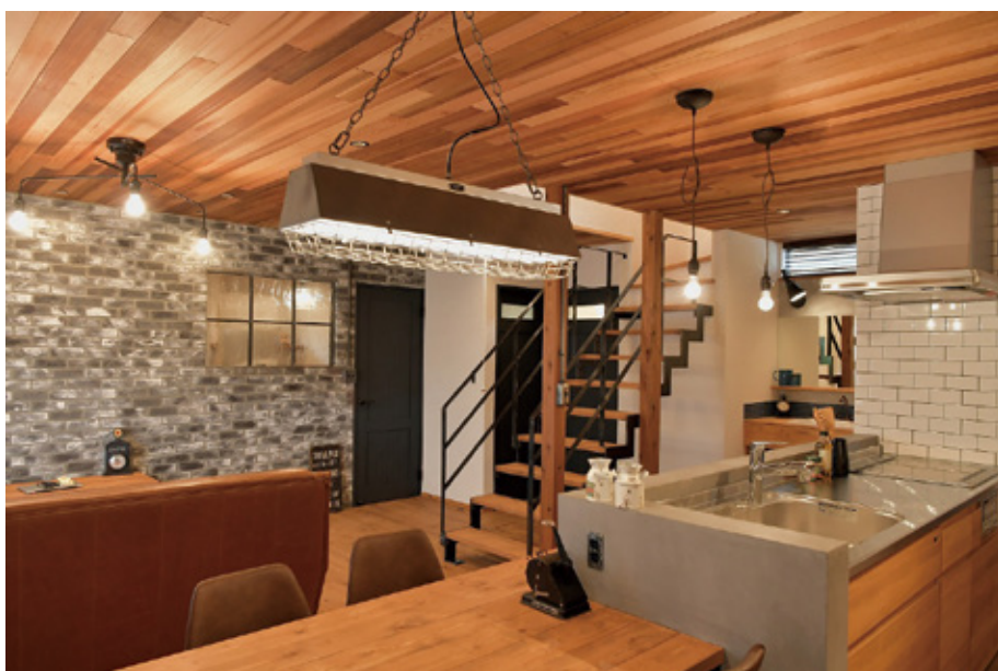
個人邸 設計：オンリーユーホーム 使用ブリック：STD-45 目地：グレー / スタンダードジョイント / 馬踏み目地
